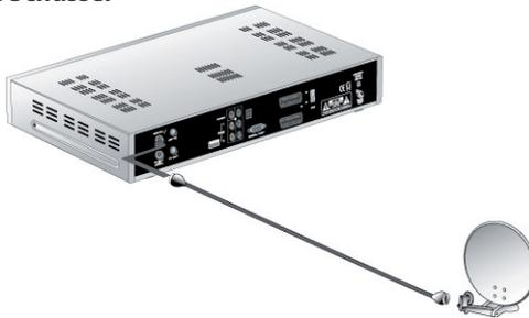
Das LNB der Antenne (Schüssel) direkt an den „LNB IN“- Anschluss verbinden.
