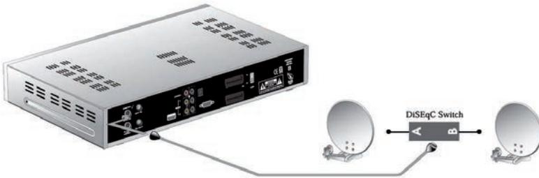
Möchten Sie einen DiSEqC-Schalter benutzen um mehrere Satelliten anzuschließen, verbinden Sie bitte Ihre FERGUSON- Settop-Box (LNB IN-Eingang hinten) mit dem LNB OUT- Ausgang Ihres Switch.
